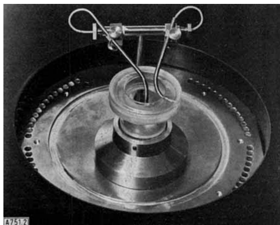
Abb. 2. Rotierender Reaktionsbecher des Protein-Sequenators nach Edman und Begg bei abgenommener Glasglocke. Die Abbildung zeigt die Teflonschlauch-Zuführung für Reagentien und Lösungsmittel sowie die tangential in einer Rille am Becherrand ansetzende, über ein Dreiwegventil mit dem Fraktions- oder Ablaufsammler verbundene Absaugleitung. Auf der heizbaren Basisplatte sind die Ein- und Austrittsöffnungen für die zirkulierende Warmluft sichtbar (50 °C, Temperaturkonstanz \pm 0.2 °C). Durchmesser der Basisplatte 18 cm. (Werkfoto der Fa. Beckman Instruments GmbH, München.)
